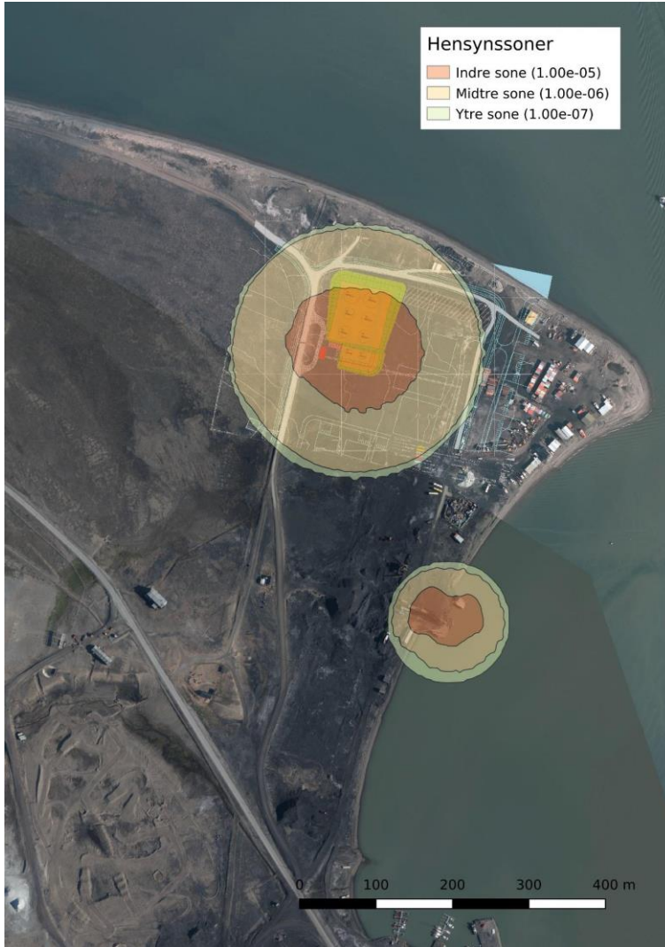
Hensynssoner for planlagt tankanlegg (Safetec, 2022)
