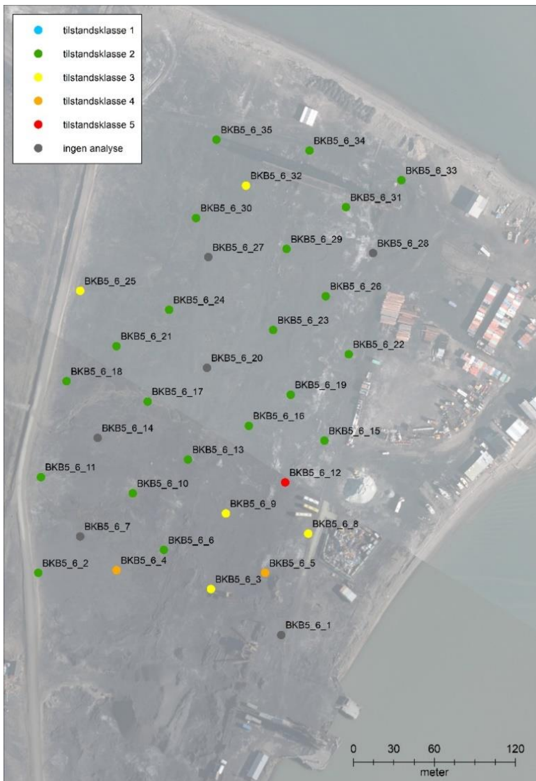
Figur 5: Miljøtilstand i overflatemasser på delområde BKB5 og 6, 0-50 cm. Prøver er fargelagt iht. høyest registrerte tilstandsklasse. Grå farge er prøver som ikke er analysert.
