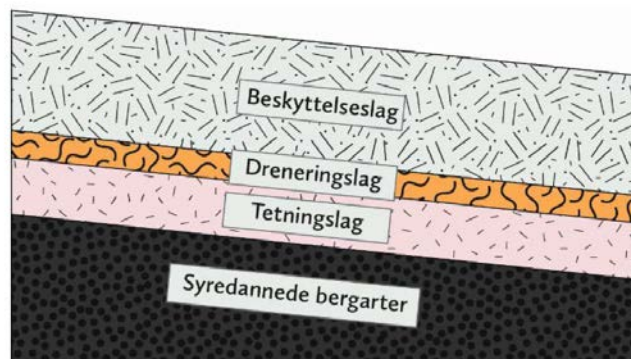
Figur 5 Skisse hvordan mulig toppdekking av massene kan utformes (i henhold til M-385)
