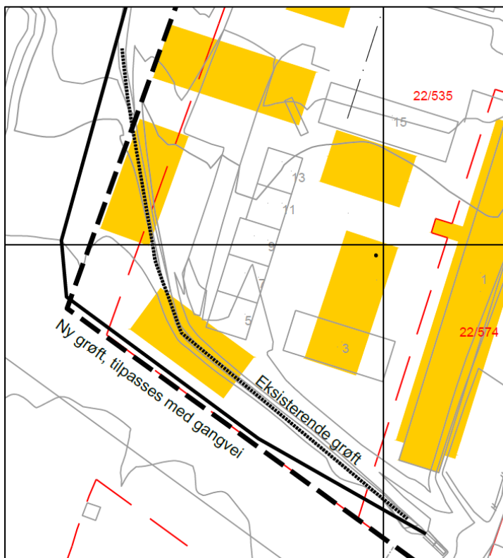
Figur: Ny overvannsdrenering sør i området.
