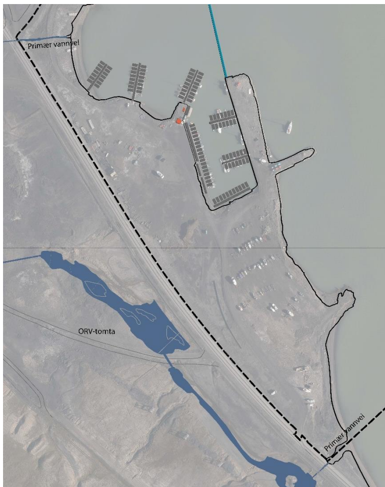
Figur 20: Smeltevann fra Blomsterdalen fraktes i kulverter nordøst og sørvest ved Småbåthavna
