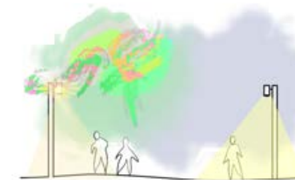
Gangvei: Mastehøyde på 4-5 meter og et 3000K lys. Lyset er dempet ved høy sannsynlighet for nordlys og en lysende flate på armaturen tennes for å danne en ledelinje.
