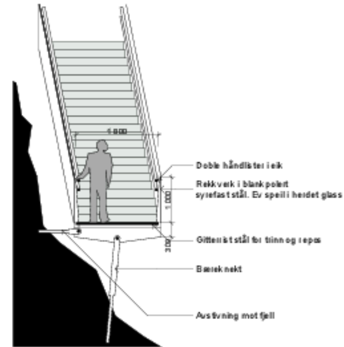
Snitt. Forslag til konstruksjon
